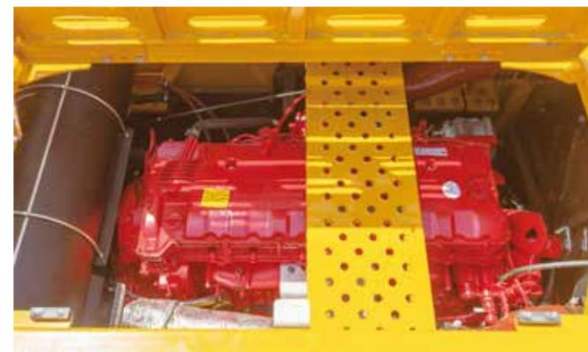
563kW大功率发动机，功率储备充足；配备分动箱，低转速、大扭矩，油耗低，效率高。无后处理系统，无需加注尿素，降低使用成本。
